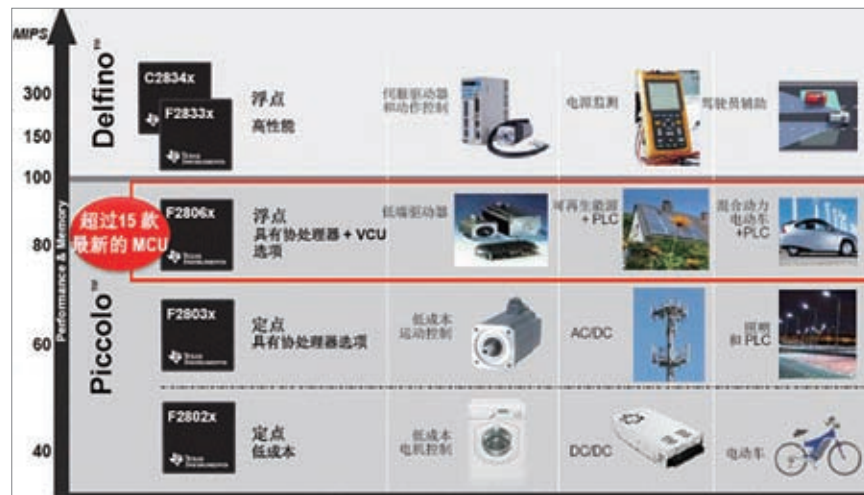
图 1: 15 款 C2000 Piccolo MCU 可为可再生能源、PLC 与电机控制提供浮点内核、最新复杂数学单元以及控制导向型外设选项。
