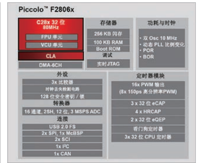
图 4: F2806x Piccolo 浮点 MCU 框图。
