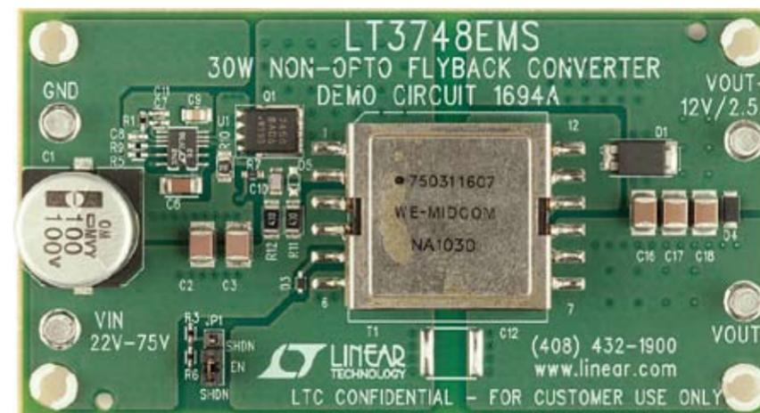
图3: LT3748 30W应用电路(尺寸: 38mm x 19mm x 9.5mm)。
