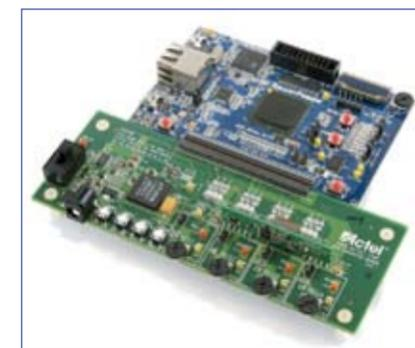
图 13: MPM 子板卡和 SmartFusion 评测工具套件板。
