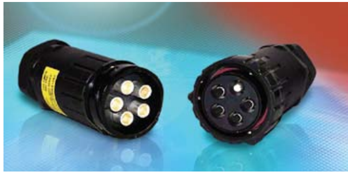
图2: ITT的CGL系列电源输入连接器基于MIL-C-5015、VG95234和CA-B标准,可与所有类似的连接器互配。
