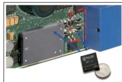
图4: Vicor 部分输入滤波模块整合了热插拔功能, 可代替十多个分立元件, 从而减少 PCB 面积、成本, 及提高系统可靠性。
